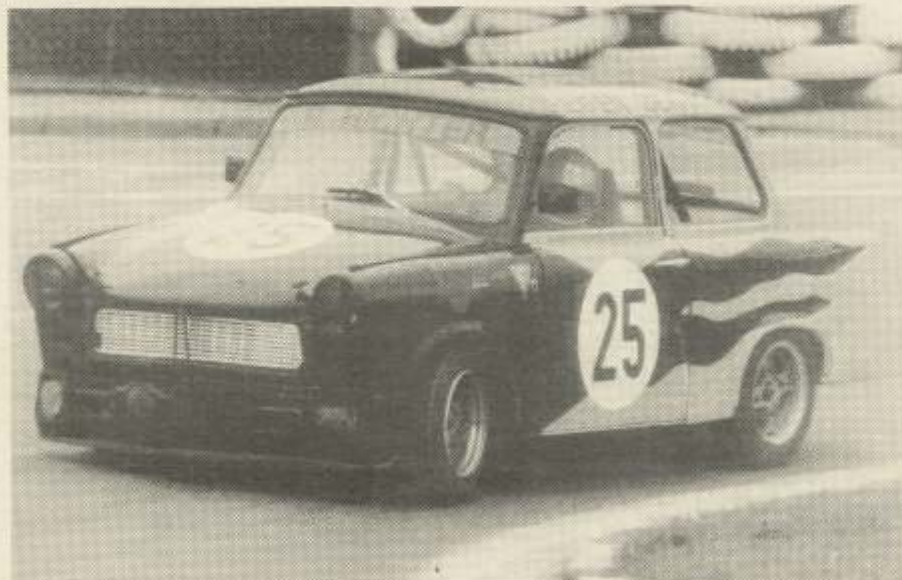
Der Star auf vielen Rennstrecken: Renn-Trabbi 601 aus Plaste mit 2 Zyl. und ca. 72 PS von Ines Richter aus Sondershausen (DDR.)
